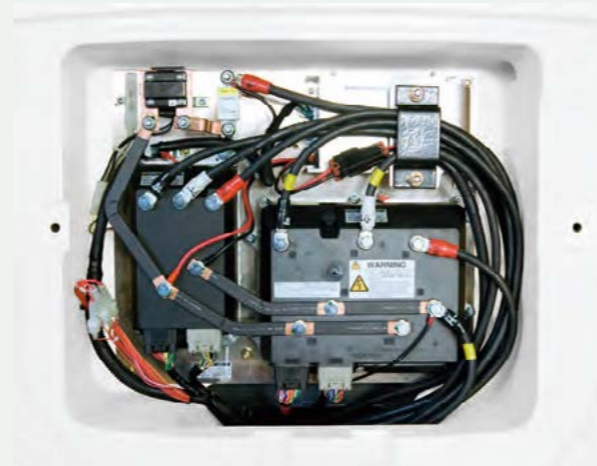
드라이브 및 유압 모터 컨트롤러가 함께 배치되어 신속한 접근과 손쉬운 서비스가 가능하다. 그리고 이러한 장치들은 먼지와 물에 대하여 강한 저항력을 가지고 있다.
