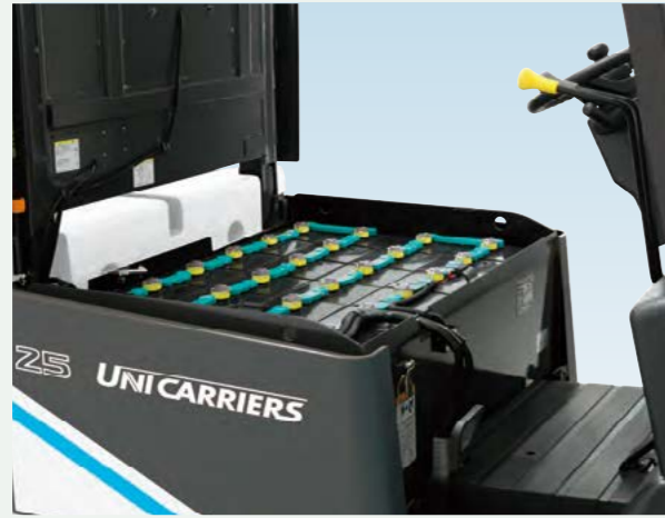
덤퍼가 장착되는 본네트는 배터리장치에 대한 쉽고 빠른 유지보수를 가능하게 한다.
